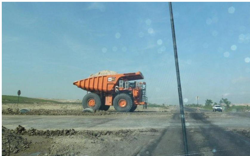
Dump truck elektrik baru dan pertama Adaro dengan kapasitas 170 ton, sebagai bagian dari upaya untuk mengurangi ketergantungan terhadap BBM
